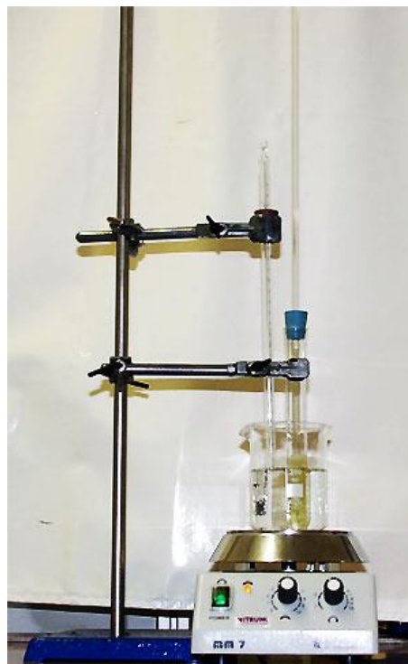
aparatura pro přípravu bionafty
