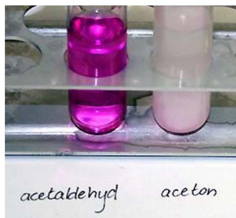
pro porovnání: reakce oxosloučenin s Schiffovým činidlem
