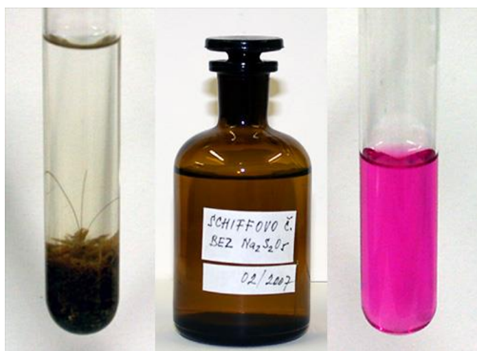
piliny z dřevotřísky – Schiffovo činidlo – po přikápnutí do extraktu z pilin
