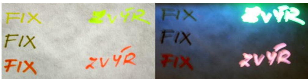
fixy a zvýrazňovače pod UV lampou
