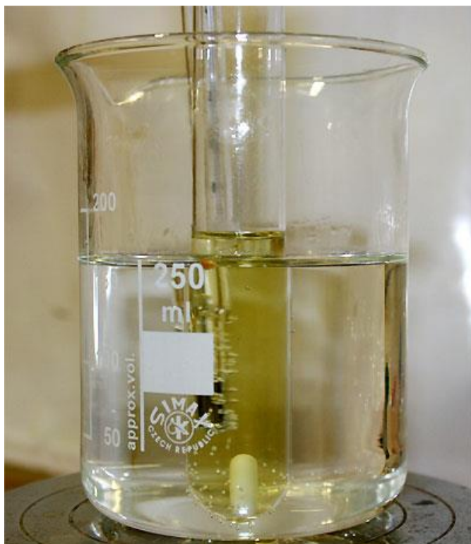
čirá reakční směs v kádince – vpravo rozvrstvení produktů: horní vrstva je bionafta
