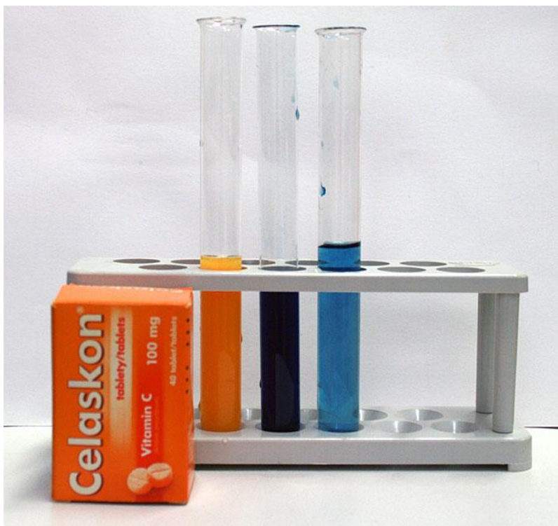
další důkazové reakce Celaskonu redukce Fehlingova činidla a vznik berlínské modři (v poslední zkumavce zředěná)
