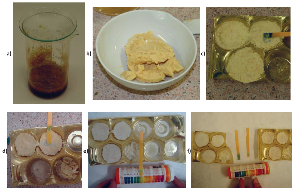
Obr. 4.5 – a) Kádinka s reagovaným sádem a hydroxidem sodným; b) Odebraná sraženina mýdla; c) Mýdlo vytlačené do formiček. pH mýdla bylo zásadité (okolo 12); d) pH mýdla po dvou dnech (okolo 8); e) pH mýdla po dvou týdnech (okolo 7); f) Srovnání pH po dvou dnech a dvou týdnech.
