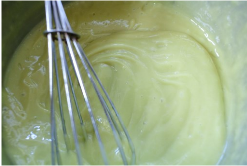
Obrázek 7 Dokončené zmydelňování, tvorba stopy za metličkou.
