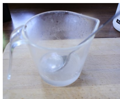
Obrázek 4 Rozpouštění hydroxidu ve vodě (na stěněch odměrky je patrná kondenzace páry, zahřívání roztoku).
